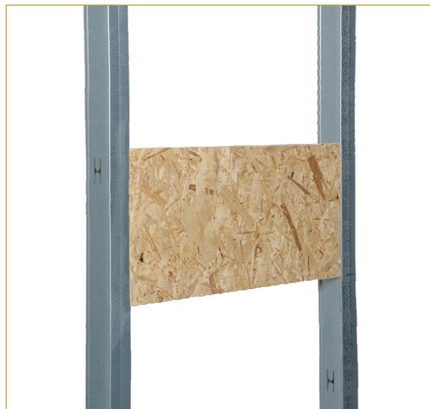
Die Traverse besteht aus einer OSB - Platte bzw. Multifunktionsplatte aus Holz. In die Platte ist eine Nut eingefräst. Durch diese Nut lässt sich die Traverse problemlos zwischen zwei CW-Profilen einbauen.
