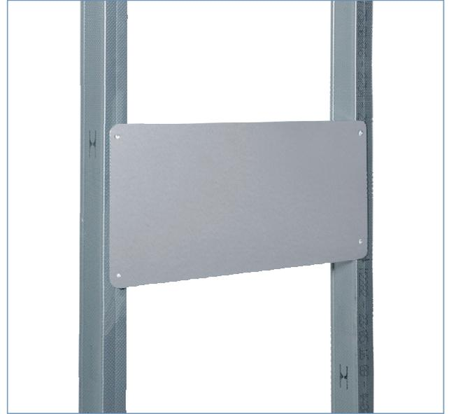
Die Traverse besteht aus verzinktem Stahlblech 0,75 mm, mit längsseitiger C-Kantung und einer Gipsfaserplatteneinlage 18 mm.
