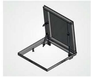
an 2 Eckpunkten. Das Öffnen wird durch eine hochwertige Gasdruckfeder so unterstützt, dass die Schachtabdeckung von nur einer Person geöffnet und geschlossen werden kann. Eine Fallschutzvorrichtung verhindert das unkontrollierte Schließen. Die Aufbauhöhe beträgt nur 77 mm.
